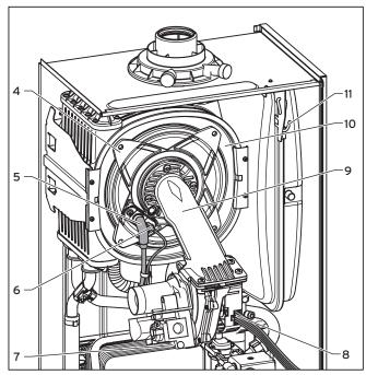
Fig. 7.2 Dismantling burner module
