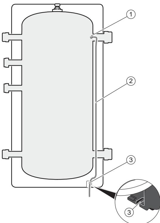
1 Compartimento de la sonda de temperatura                    3 Paso del cable de la sonda de temperatura
