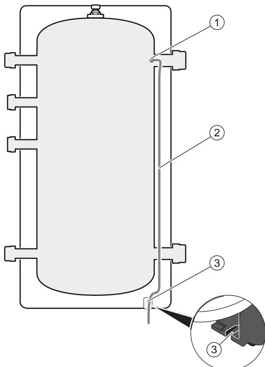
1 Uložení teplotního čidla      3 Průchod kabelu teplotního čidla
